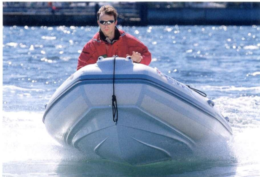
Das mäßig aufgeklümmte Unterwasserschiff besteht aus weißem GFK
