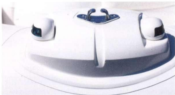
Das freundlich dreinschauende „Froschgesicht“ besitzt neben den Positionslichtern, die nicht BSH-attestiert sind, eine stählerne Lippklüse für die Vorleine
