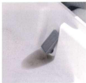
Der vordere und hintere Innenraum des Cockpits ist selbstlenzend und durch einen Hebel zu schließen
